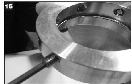
**ВАЖНОЕ ПРИМЕЧАНИЕ.** Установочные винты не должны выступать внутрь внутреннего диаметра стопорного кольца перед установкой на втулку уплотнения.
