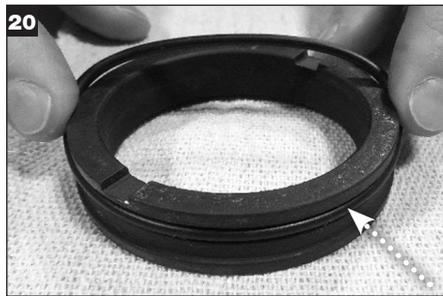
Нанесите тонкий слой консистентной смазки на вращающееся уплотнительное кольцо (W) и установите его в паз на наружной поверхности наружного вращающегося кольца уплотнения.
