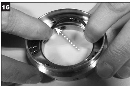
Нанесите тонкий слой консистентной смазки на уплотнительное кольцо (Y) стопорного кольца и установите его в канавку на внутреннем диаметре стопорного кольца.
