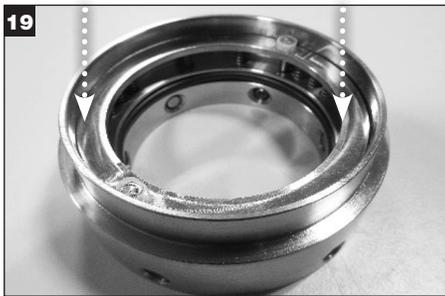
Совместите штифты узла толкателя с маркированными отверстиями в стопорном кольце и надавите для размещения в нужном положении.
