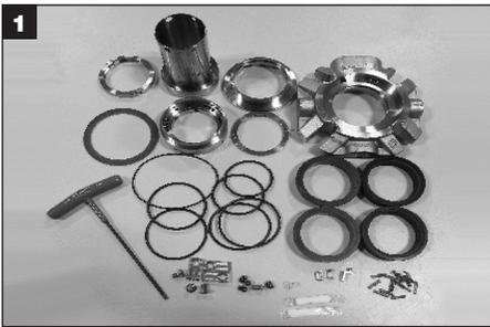
Инструменты, необходимые для установки уплотнения. Шестигранный ключ и два вида консистентной смазки (поставляются с уплотнением); безворсовая ткань, пинцет или тонкий остроконечный инструмент (поставляются заказчиком; для установки уплотнительных колец и приводной трубы). Очистите утвержденным растворителем все металлические компоненты, включая все поверхности прокладок и уплотнительных колец. Поместите металлические компоненты и все запасные компоненты уплотнения на чистую сухую поверхность.
