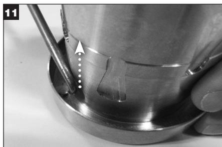
Удалите приводную трубу из поводков привода втулки и утилизируйте.
