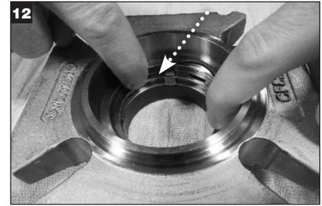
Аккуратно переверните сальник и положите его на чистую ткань, чтобы защитить внутреннюю уплотнительную поверхность. Нанесите тонкий слой консистентной смазки на оставшееся неподвижное уплотнительное кольцо (X) и установите в паз на внутреннем диаметре сальника.
