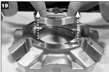
19 Удалите канал привода из сальника; удалите зажимы канала и дефлектор потока из канала и утилизируйте.
